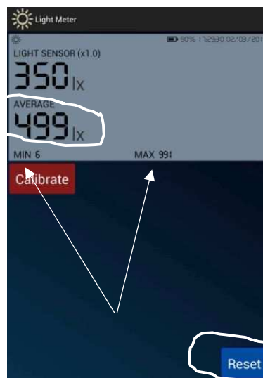
3. Ábra. A „Light Meter” alkalmazás képernyője a mérés során használandó funkciók megjelölésével
